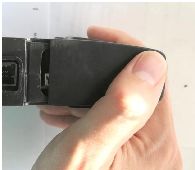
Рисунок 4.1 Открытие отсека АКБ
